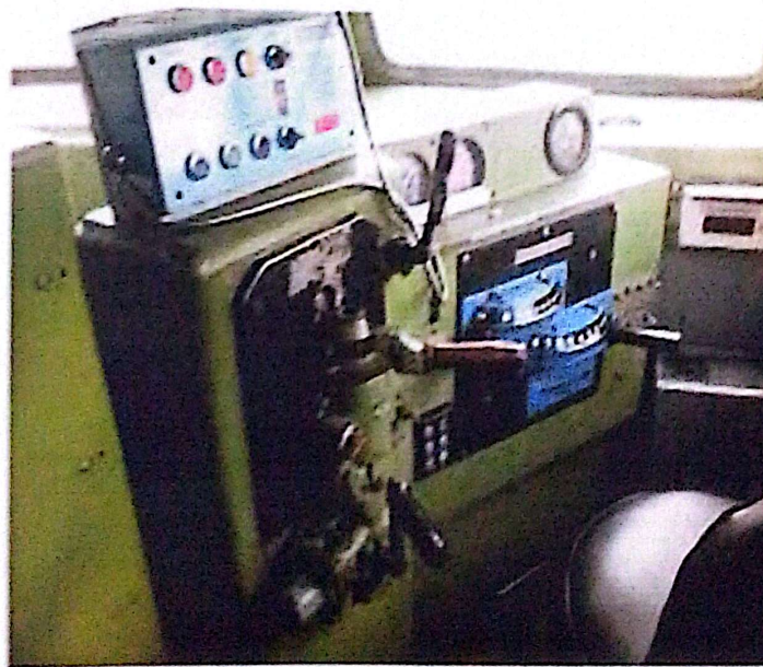
Gambar 2. 9 Sistem Pengereman Pada Lokomotif CC 203
