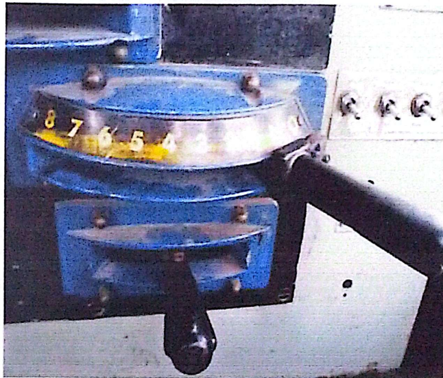
Gambar 2. 17 Tuas Rem Dinamik atau Electrodynamic Brake
