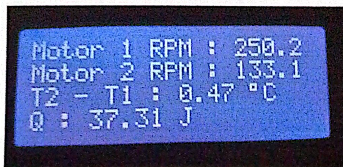
Gambar 3.15 Tampilan LCD pada Pengujian Sensor Suhu dengan Pejal 1
