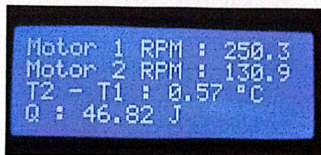
Gambar 3.16 Tampilan LCD pada Pengujian Sensor Suhu dengan Pejal 2
