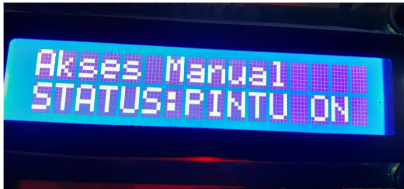
Gambar 4.6 Pengujian sensor Touch berhasil ditampilkan pada LCD 16x2.
