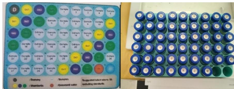
**Gambar 3.5.** Konfigurasi vial di dalam *autosampler tray* (kiri) dan *autosampler tray* pada PAL *autosampler* (kanan)
