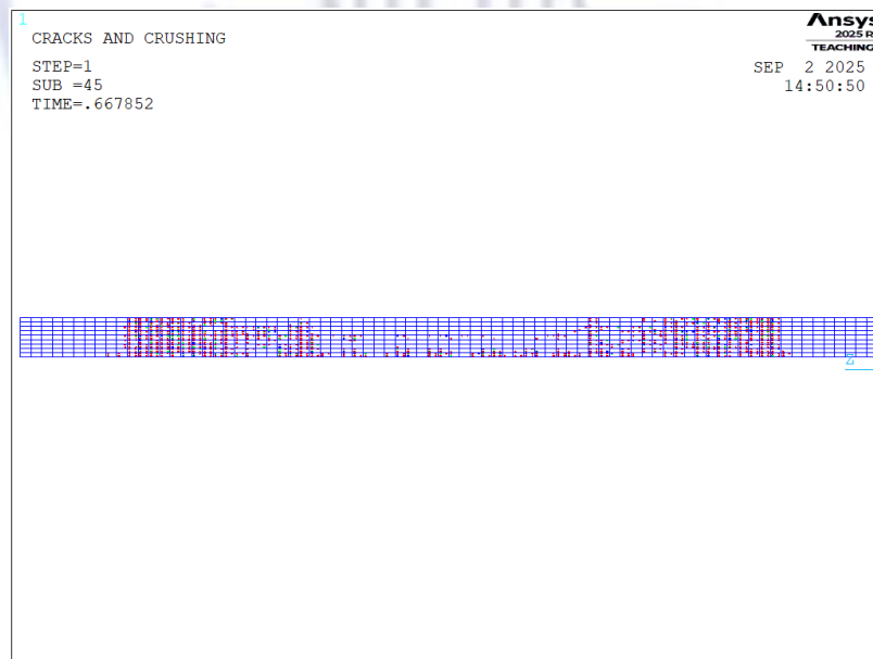
Gambar 4. 10 Pola Retak Ketiga Balok Beton Sandwich (Material Properti: Beton Sandwich )
